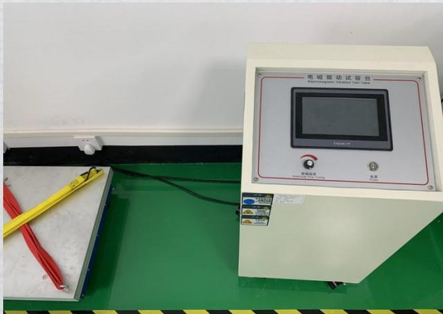
电磁振动测试台
